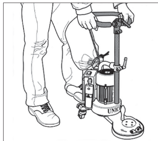
Obr. 39 Broušení s bruskou UNICO v podřepu při spuštěné vodící trubici.
